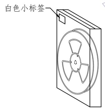
**NO4:** 将卷盘套上PE-32防水袋,放入1包干燥剂,真空机封口后装入内箱,用封箱胶封装好,贴上标签。(1卷盘/内箱,XXXXpcs/内箱)
