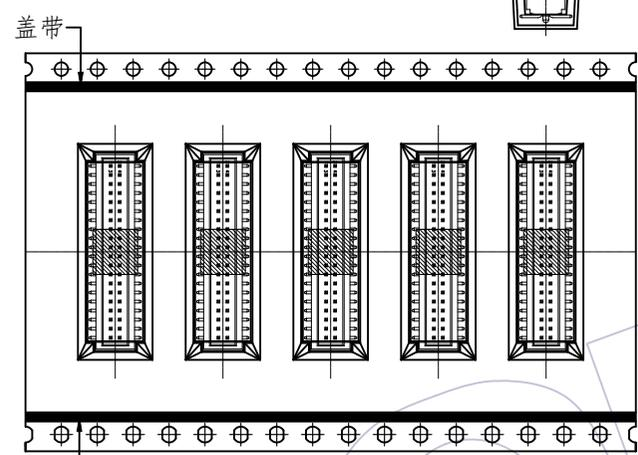
**NO2:** 将产品放入载带凹槽后,用盖带封装(冷封)
