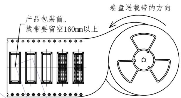
**NO1:** 产品包装前,注意载带要留空160mm以上,以及卷盘送载带的方向按逆时针旋转
