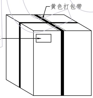
**NO5:** 在外箱内放入PE-18防水袋,将所有内箱放入防水袋内,封箱打包,并贴上标签。(5内箱/外箱,XXXXpcs/外箱)
